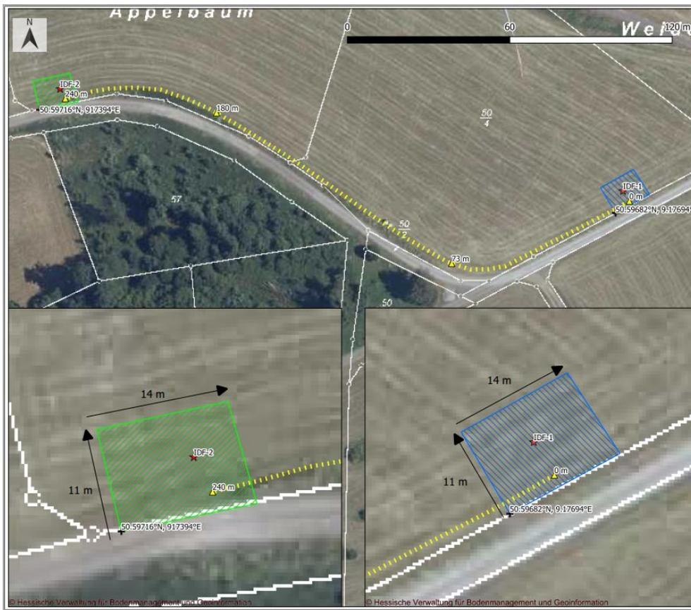
**Abbildung 5: Skizze der benötigten Flächen und Kabelverlegung für IDF (jeweils ca. 154 m<sup>2</sup>)**
